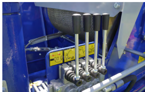
Kvalitní hydraulické rozvaděče pro funkce na rozložení stroje
